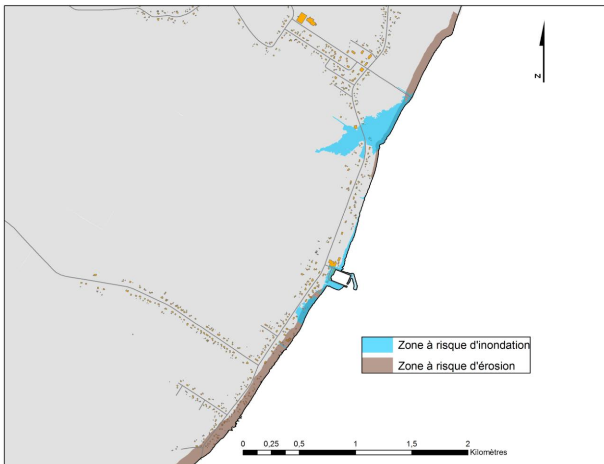
Figure 1 : Zones à risque d'inondation et d'érosion côtières à Sainte-Marie-Saint-Raphaël
